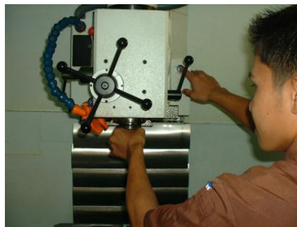
รูปที่ 8.11 กดปุ่มข้างหัวเครื่อง เพื่อจับยึด Arbor
