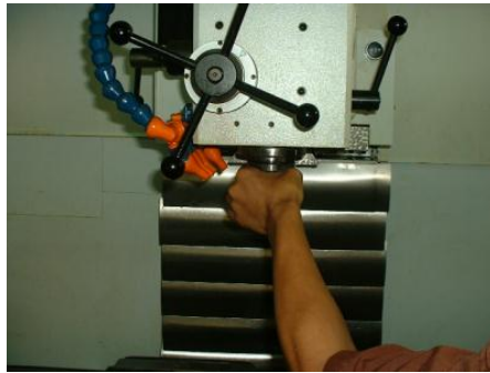
รูปที่ 8.10 การประกอบ Tool เข้ากับ Arbor ของ เครื่อง
