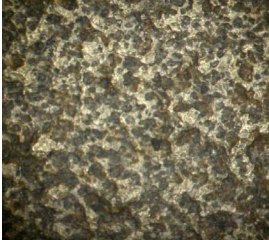
รูปที่ 5 ลักษณะผิวภายนอกชิ้นงานหล่อของอัตราส่วนผสมของแบบหล่อทรายแบบเดิมของโรงงานการศึกษา
