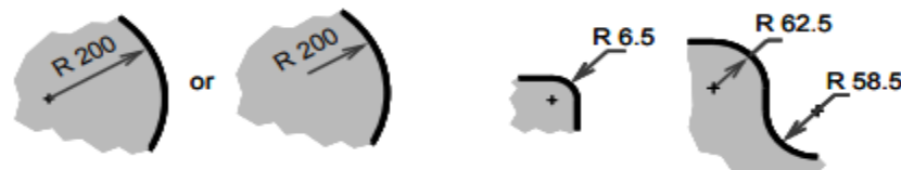
รูปที่ 6 การบอกขนาดของส่วนโค้ง [1] รูปที่ 7 การบอกขนาดของราวด์และฟิลเลต [1]
