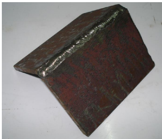
รูปที่ ๕.๕๒ แสดงลักษณะมุมลวดเชื่อมในการต่อมุมทำระดับ
