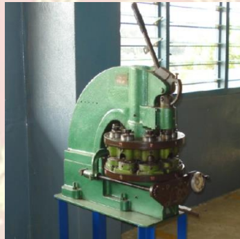
รูปที่ ๖.๓๗ แสดงลักษณะเครื่องตัดเจาะรูหลายหัว (Turret Punch)
