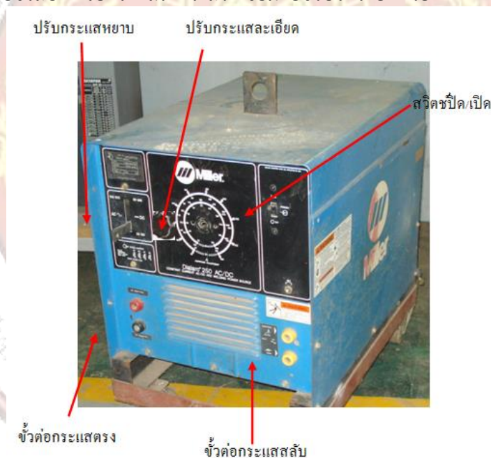
รูปที่ ๕.๑๙ แสดงรูปเครื่องเชื่อมแบบหม้อแปลง - เรียงกระแส
