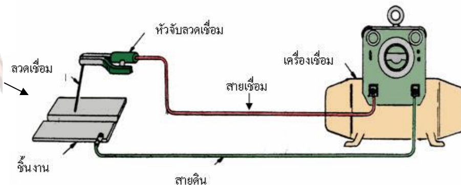
รูปที่ ๕.๒ แสดงวงจรพื้นฐานของการเชื่อมอาร์กลวดหุ้มฟลักซ์
