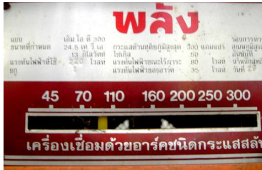
รูปที่ 5.39 แสดงการปรับตั้งขนาดกระแสไฟ 95 แอมแปร์ ในการเชื่อมต่อชนทำราบ
