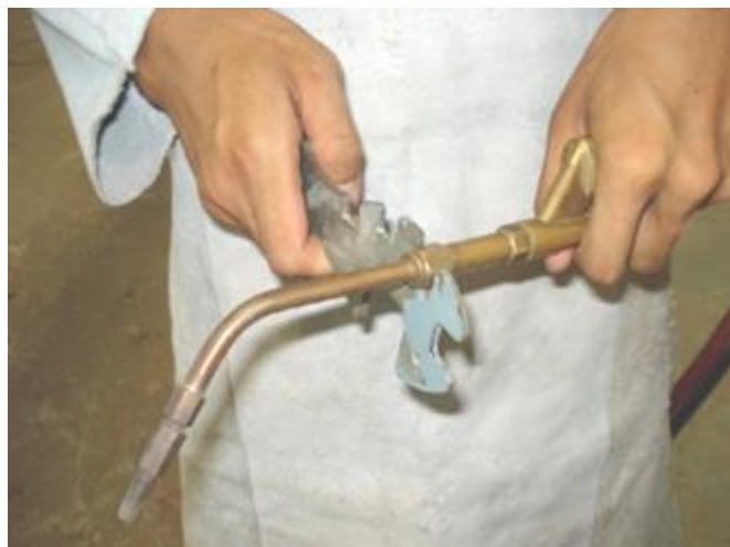
รูปที่ ๑.๒๕ แสดงการประกอบหัวเชื่อมแก๊สและหัวทิฟ
