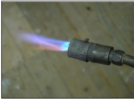
รูปที่ ๓.๑๖ แสดงเปลวแก๊สโพรเพน กับออกซิเจน ในการเชื่อมประสาน ที่มา : content.answers.com
