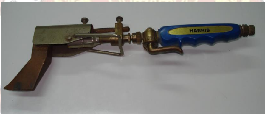
รูปที่ ๙.๓ แสดงหัวบัดกรีชนิดที่เกิดความร้อนด้วยตัวเอง (ชนิดที่ใช้แก๊สโพรเพน)
