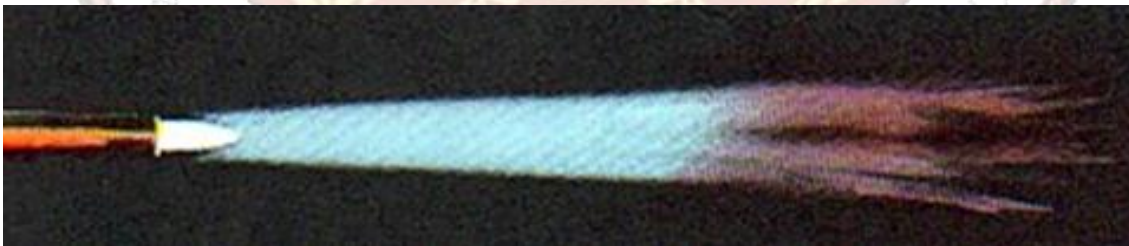
รูปที่ ๑.๔๘ แสดงเปลวออกซิไดซิง (Oxidizing Flame) ที่มา : ALTHOUSE,TURNQUIST,BOWDITCH. ๑๙๘๐ : ๒๙
