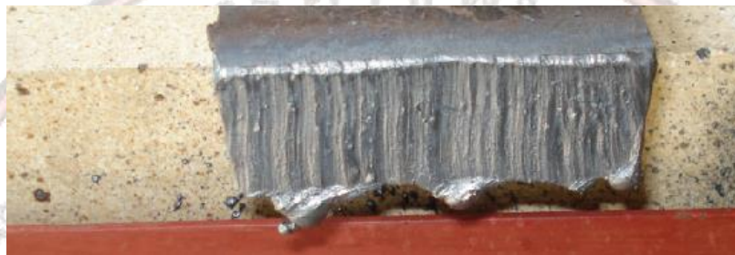
รูปที่ ๔.๑๒ แสดงลักษณะรอยตัดที่ไม่ดี หัวทิพสกปรก และการผสมของแก๊สไม่เหมาะสม ๔.๓.๓ ลำดับขั้นตอนการตัด
