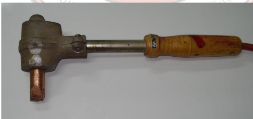
รูปที่ ๙.๓ แสดงหัวบัดกรีชนิดที่เกิดความร้อนด้วยตัวเอง (ชนิดที่ใช้แก๊สโพรเพน)
