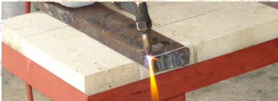
รูปที่ ๔.๑๓ แสดงการเริ่มต้นตัดที่ขอบของชิ้นงานโดยเอียงทิพตัดเข้าหาชิ้นงานเล็กน้อย
