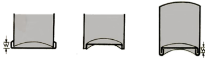
รูปที่ 8.12 แสดงวิธีเข้าตะเข็บกันสวมในกระป๋อง
