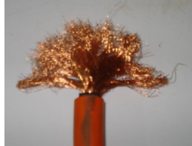
รูปที่ ๕.๒๕ แสดงสายเชื่อมและลักษณะภายในของสายเชื่อม
