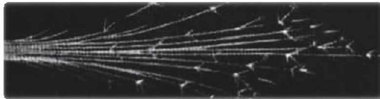
ลักษณะประกายไฟเหล็กกล้าคาร์บอนสูง
