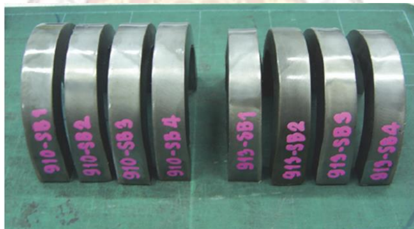
ชิ้นทดสอบที่ถูกดัดเป็นรูปตัวยู (U-Bend)
