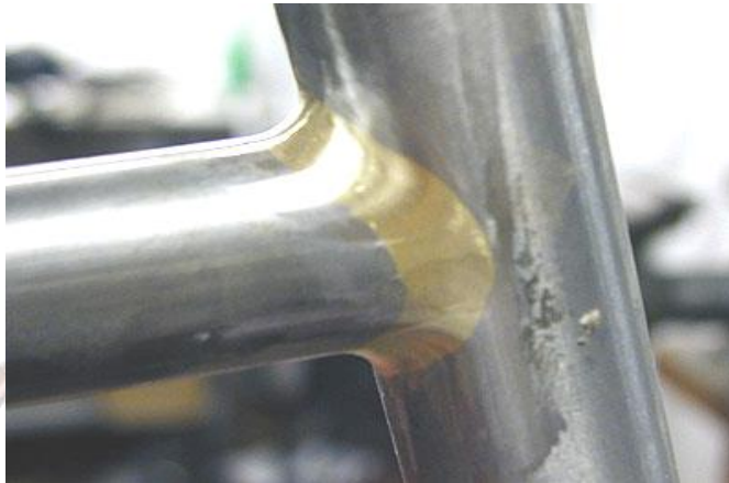
รูปที่ 3.1 แสดงรูปแบบการแล่นประสานของชิ้นงาน
