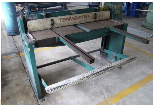
รูปที่ 6.32 แสดงลักษณะเครื่องตัดตรงชนิดทำเหยียบ
