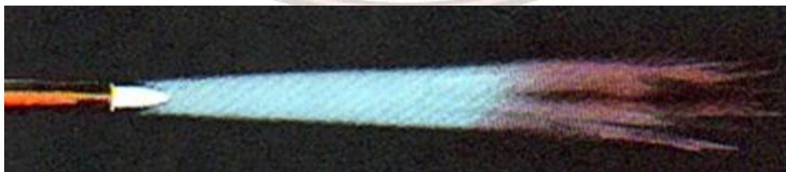
รูปที่ 1.48 แสดงเปลวออกซิไดซิง (Oxidizing Flame)
