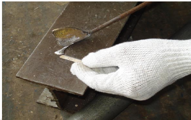
รูปที่ 9.13 แสดงการใช้ปลายหัวแร้งแตะกับแท่งโลหะบัดกรี
