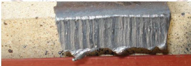
รูปที่ 4.12 แสดงลักษณะรอยตัดที่ไม่ดี หัวตัดสกปรก และการผสมของแก๊สไม่เหมาะสม
