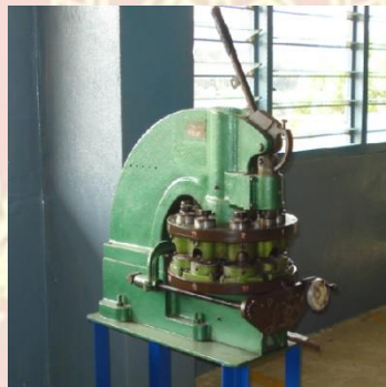
รูปที่ 6.37 แสดงลักษณะเครื่องตัดเจาะรูหลายหัว (Turret Punch)
