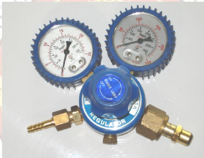
รูปที่ 1.32 แสดงเครื่องควบคุมความดันแก๊สออกซิเจนแบบสองชั้นตอน (Two-Stage Regulators)
