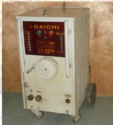
รูปที่ 5.16 แสดงรูปเครื่องเชื่อมแบบหม้อแปลงต่อกะบายออกมาจากขดลวดทุติยภูมิ
