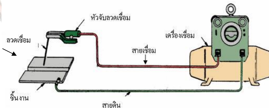
รูปที่ 5.2 แสดงวงจรพื้นฐานของการเชื่อมอาร์กลวดหุ้มฟลักซ์
