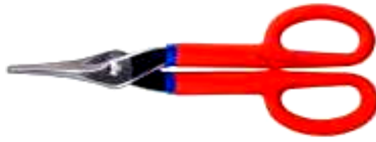
รูปที่ 6.25 แสดงลักษณะกรรไกรตัดแบบผสม
