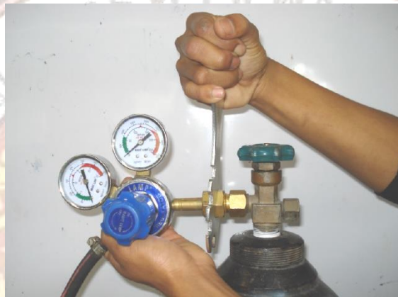
รูปที่ 1.21 แสดงการประกอบเครื่องควบคุมความดันถังแก๊สออกซิเจน
