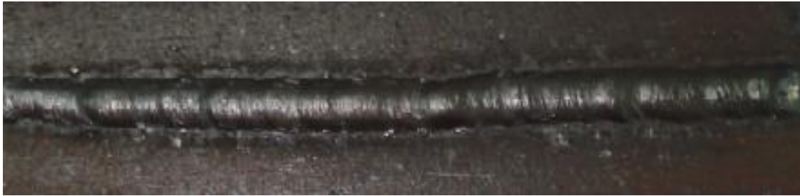
รูปที่ 5.41 แสดงแนวเชื่อมที่ใช้กระแสไฟฟ้าต่ำ
