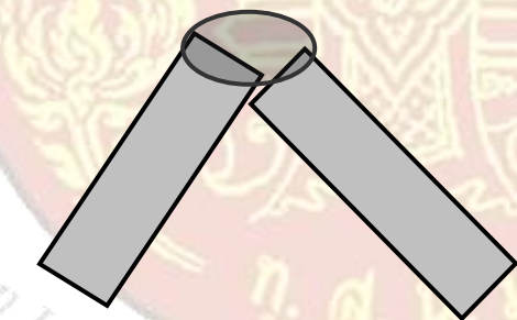
รูปที่ 5.49 แสดงการเชื่อมเต็มมุม (Ful open corner weld)
