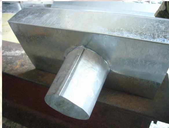
รูปที่ 9.17 แสดงการประกอบชิ้นงานรางน้ำด้วยการบัดกรี
