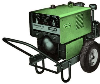
รูปที่ 5.15 แสดงเครื่องเชื่อมกระแสตรงขับเคลื่อนด้วยเครื่องยนต์
