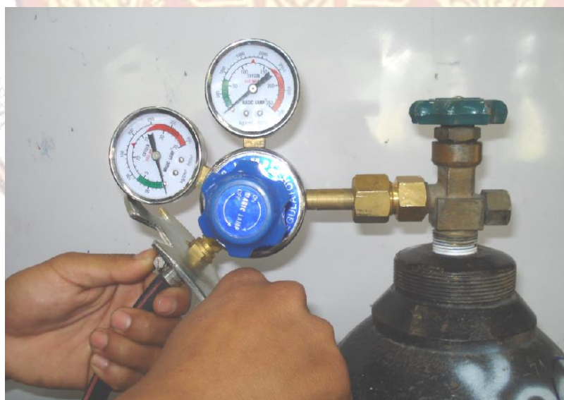
รูปที่ 1.22 แสดงการประกอบสายเชื่อมเข้ากับเครื่องควบคุมความดันแก๊สออกซิเจน
