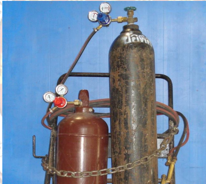
รูปที่ 1.9 แสดงการยึดถังต้องให้แน่นด้วยโซ่และจัดหัวปรับแก๊สให้อยู่ในตำแหน่งลดหลั่นกัน
