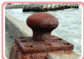
ภาพที่ 10.1 ลักษณะของการกัดกร่อนแบบสม่ำเสมอ
