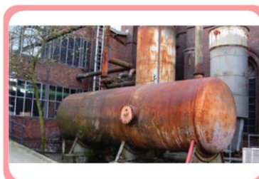
ภาพที่ 10.1 ลักษณะของการกัดกร่อนแบบสม่ำเสมอ
