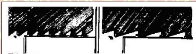
รูป แสดงลักษณะพื้นเลื่อยที่ใช้กับวัสดุงานชนิดต่างๆ
