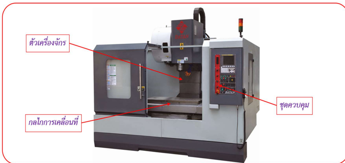
รูปที่ 1.3 ส่วนประกอบของเครื่องจักรกลซีเอ็นซี
