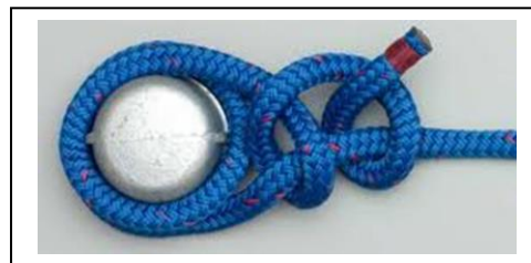
ภาพที่ 9.11 การผูกเงื่อนกระหวัดไม้สองรอบ
