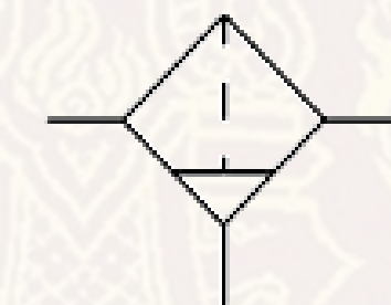
ระบายน้ำด้วยมือ
