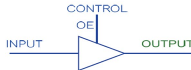
(ข) สัญลักษณ์บัฟเฟอร์สามสถานะ Output enable : active high
