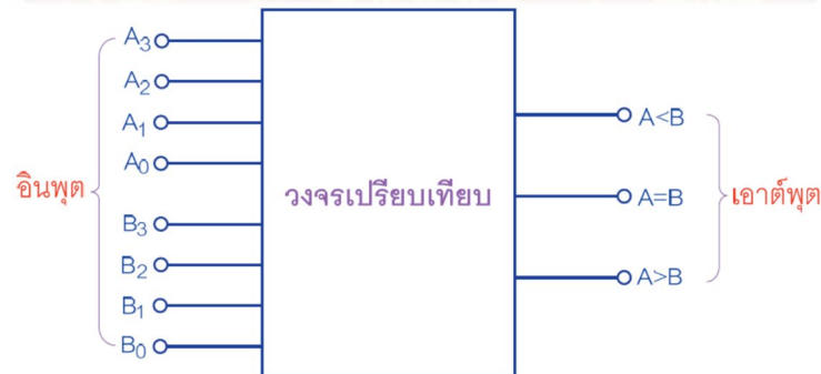
รูปที่ 5.14 ไดอะแกรมการเปรียบเทียบข้อมูล 4 บิต 2 จำนวน
