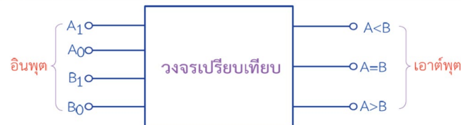
รูปที่ 5.13 ไดอะแกรมการเปรียบเทียบข้อมูล 2 บิต 2 จำนวน
