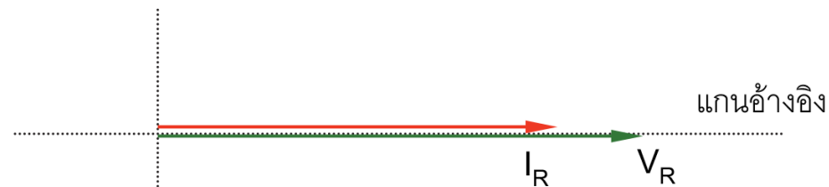
รูปที่ 5.2 เฟสเซอร์ไดอะแกรมของแรงดัน V_R กับกระแส I_R
