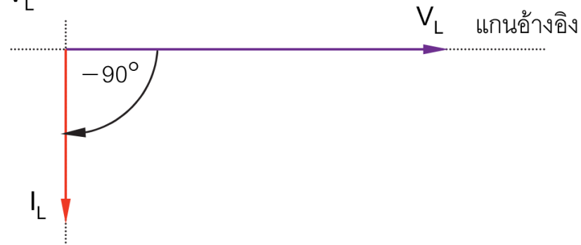
รูปที่ 5.6 เฟสเซอร์ไดอะแกรมของแรงดัน V_L กับกระแส I_L
