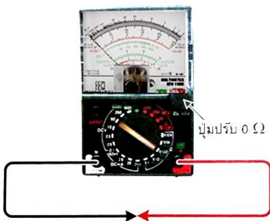
รูปที่ 8.14 การปรับแต่งโอห์มมิเตอร์ให้ชี้ที่ 0 \Omega พอดี
