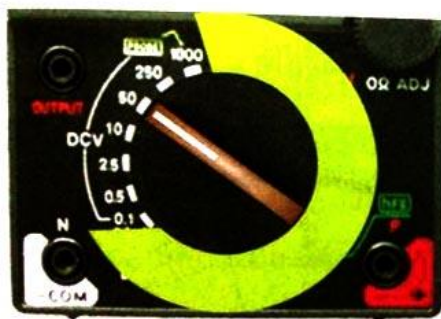
รูปที่ 8.4 ย่านวัดแรงดันไฟฟ้ากระแสตรง (DCV)
