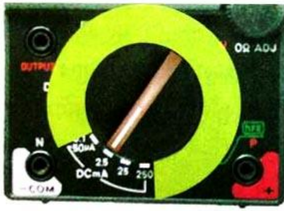
รูปที่ 8.10 ย่านวัดกระแสไฟฟ้ากระแสตรง (DCmA)
