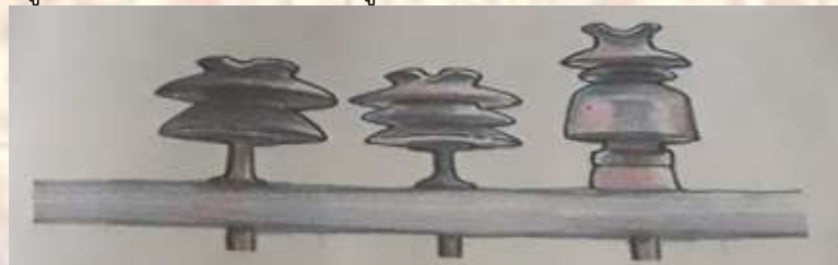
รูปที่ 6.1 การติดตั้งลูกถ้วยกับไม้คอน
