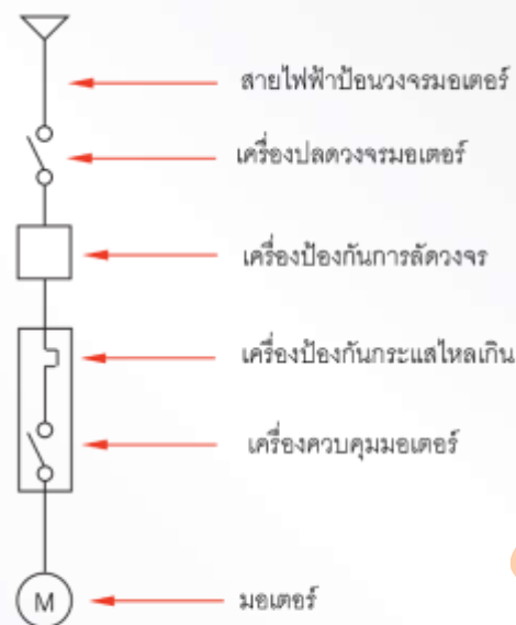
รูปที่ 3.1 ส่วนประกอบของวงจรไฟฟ้าสำหรับมอเตอร์
