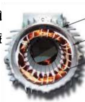
รูปที่ 6.2 ตัวอยู่กับที่ของมอเตอร์ไฟฟ้ากระแสสลับ 3 เฟสแบบเหนี่ยวนำ
