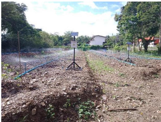
รูปที่ 4 การทดลองใช้งานระบบการจ่ายน้ำเพื่อการเกษตร สื่อสารระยะไกล
