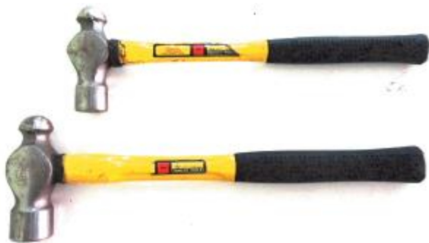
รูปที่ 2.3 แสดงลักษณะค้อนใช้ในการตักแต่งชิ้นงานเชื่อมอาร์กทั้งสแตนเลสและเหล็ก
