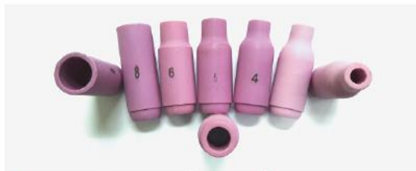
รูปที่ 1.8 แสดงลักษณะหัวฉีดที่ใช้ในงานเชื่อมอาร์กทั้งสเตนอิลแก๊สคลุม
