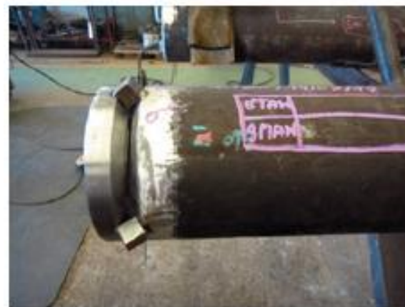
รูปที่ 3.15 แสดงลักษณะงานเชื่อมเหล็กกล้าคาร์บอนด้วยการเชื่อมอาร์กทั้งสแตนแก๊สคลุม
