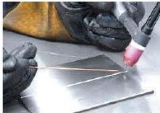
รูปที่ 3.17 ลักษณะงานเชื่อมอะลูมิเนียมด้วยการเชื่อมอาร์กทั้งสแตนเลสคลุม
