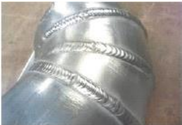
รูปที่ 3.17 ลักษณะงานเชื่อมอะลูมิเนียมด้วยการเชื่อมอาร์กทั้งสแตนเลสคลุม
