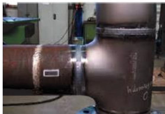
รูปที่ 3.16 แสดงลักษณะงานเชื่อมเหล็กกล้าไร้สนิมด้วยการเชื่อมอาร์กทั้งสแตนแก๊สคลุม
