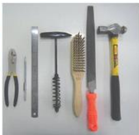
รูปที่ 5.4 แสดงอุปกรณ์อำนวยความสะดวกก่อนเชื่อม ขณะเชื่อม และหลังเชื่อม
