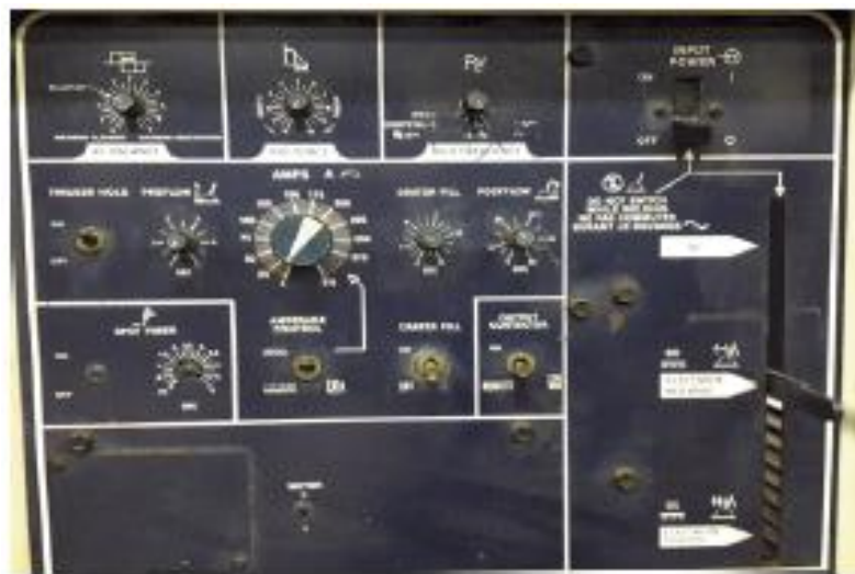
รูปที่ 5.1 แสดงแผนภูมิการปรับพารามิเตอร์ของเครื่องเชื่อมอาร์กทั้งสแตนแก๊สคลุม
