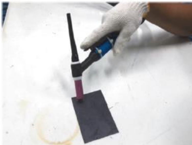
รูปที่ 6.4 วิธีการจับหัวเชื่อมแบบทั่วไป
