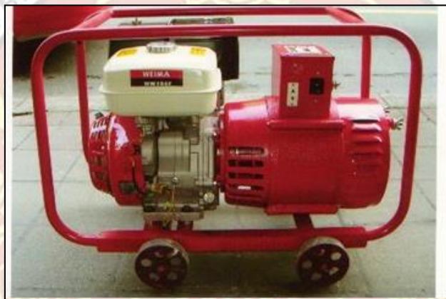
เครื่องเชื่อมกระแสตรงขับเคลื่อนด้วยเครื่องยนต์
