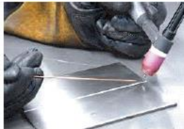
รูปที่ 3.17 ลักษณะงานเชื่อมอะลูมิเนียมด้วยการเชื่อมอาร์กทั้งสแตนเลสและอลูมิเนียม
