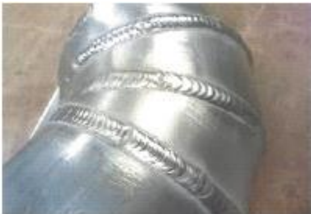
รูปที่ 3.17 ลักษณะงานเชื่อมอะลูมิเนียมด้วยการเชื่อมอาร์กทั้งสแตนเลสและอลูมิเนียม
