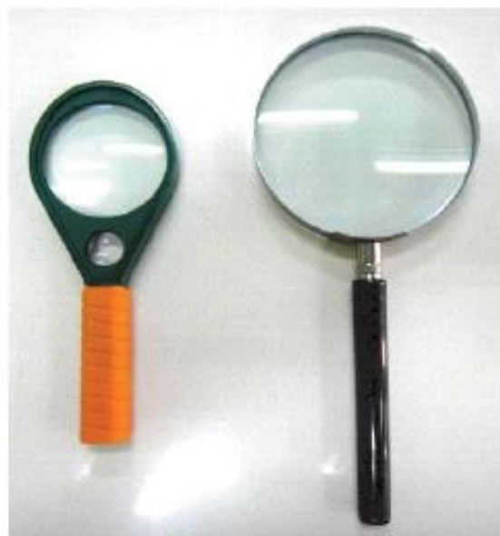
รูปที่ 2.13 แสดงลักษณะแว่นขยายสำหรับใช้ตรวจสอบงานเชื่อม
