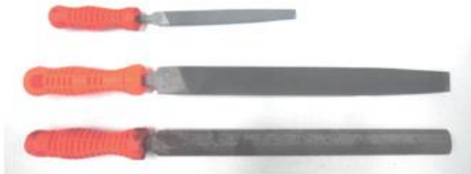
รูปที่ 2.6 แสดงลักษณะตะไบตกแต่งชิ้นงานเชื่อม
