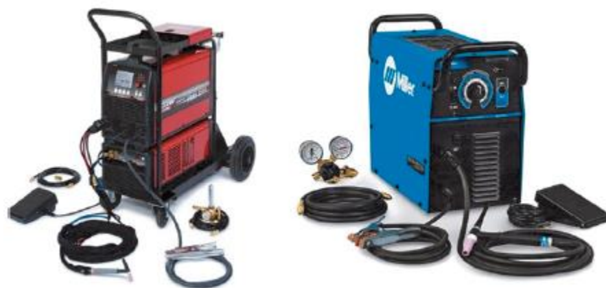
รูปที่ 1.3 แสดงลักษณะเครื่องเชื่อมงานเชื่อมอาร์กทั้งสแตนแก๊สคลุม
