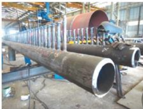
รูปที่ 3.15 แสดงลักษณะงานเชื่อมเหล็กกล้าคาร์บอนด้วยการเชื่อมอาร์กทั้งสแตนแก๊สคลุม
