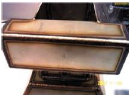
รูปที่ 3.16 แสดงลักษณะงานเชื่อมเหล็กกล้าไร้สนิมด้วยการเชื่อมอาร์กทั้งสแตนแก๊สคลุม
