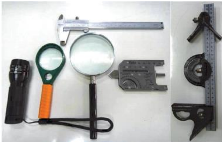
รูปที่ 4.1 แสดงลักษณะอุปกรณ์การตรวจสอบงานเชื่อมด้วยการพินิจ
