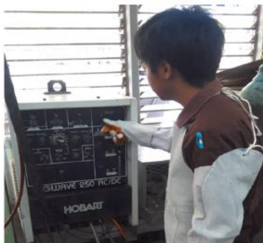
รูปที่ 2.16 แสดงการปิดเครื่องเชื่อมทุกครั้งเมื่อปฏิบัติงานเสร็จ
