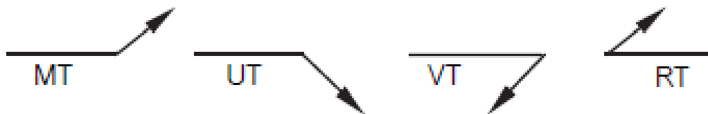
รูปที่ 4.7 แสดงการระบุสัญลักษณ์การตรวจสอบด้านเดียวกับลูกศรชี้
