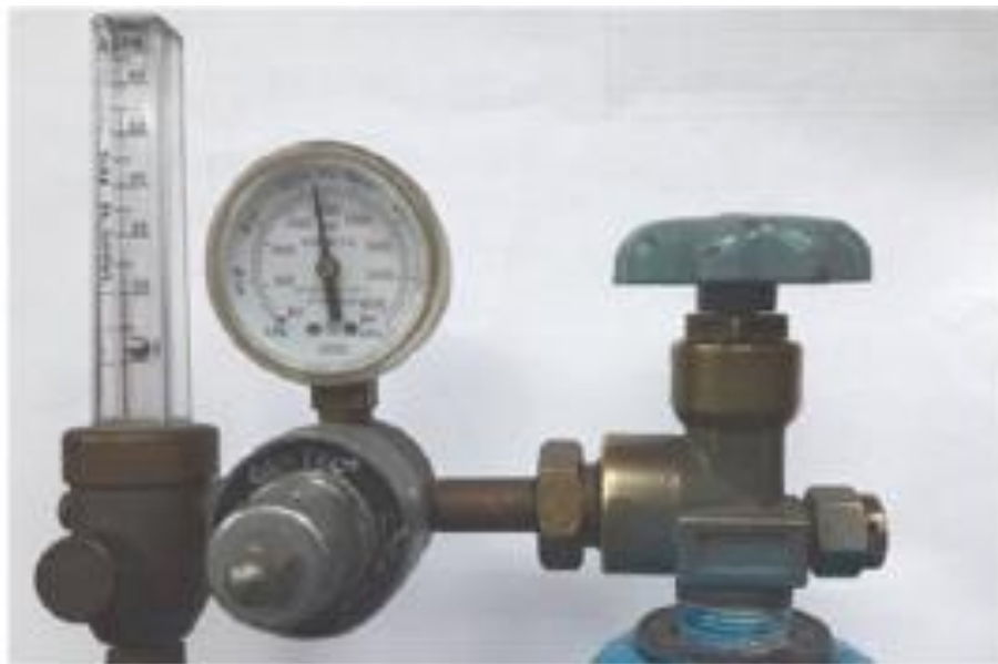
รูปที่ 5.2 แสดงชุดควบคุมการไหลของแก๊สของเครื่องเชื่อมอาร์กทั้งสแตนเลสคลุม
