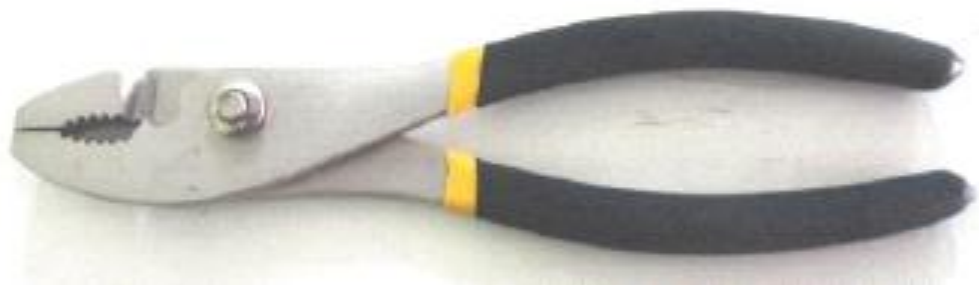
รูปที่ 2.4 แสดงลักษณะคีมจับชิ้นงานเชื่อม
