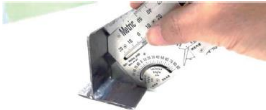
รูปที่ 9 การตรวจสอบแนวเชื่อมวัดด้วยเกจวัดขนาดแนวเชื่อม 1
