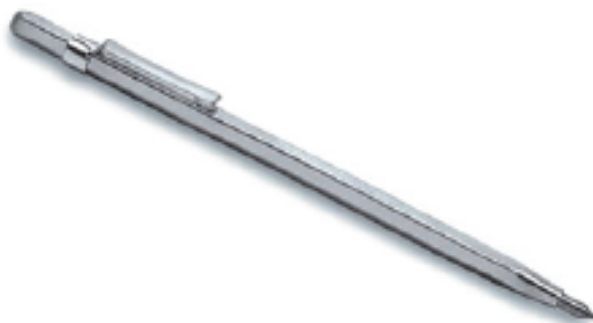
รูปที่ 2.8 แสดงลักษณะเหล็กขีดสำหรับร่างแบบชิ้นงานเชื่อม
