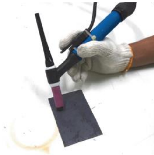
รูปที่ 6.3 วิธีการจับหัวเชื่อมแบบปากกา
