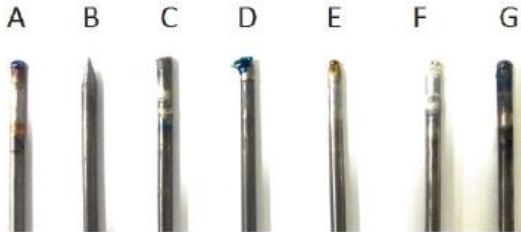
รูปที่ 1.16 แสดงลักษณะสภาพปลายแท่งทั้งสแตนอเล็กโทรด
