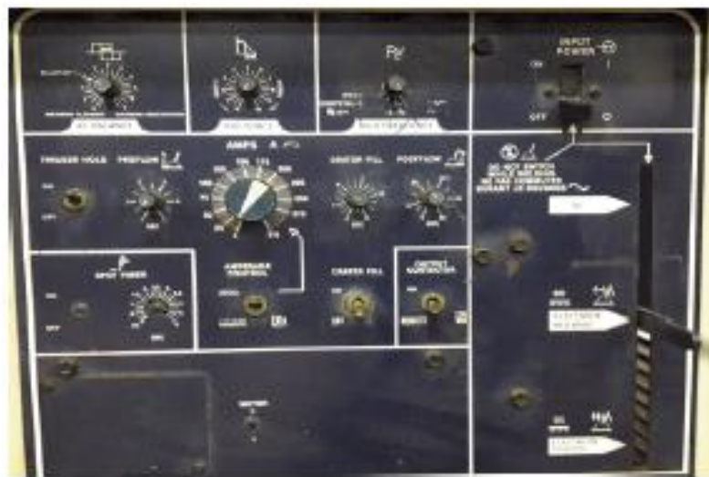
รูปที่ 5.1 แสดงแผงปรับพารามิเตอร์ของเครื่องเชื่อมอาร์กทั้งสแตนแก๊สคลุม
