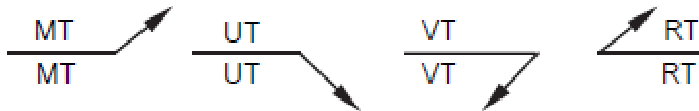
รูปที่ 4.8 การระบุสัญลักษณ์การตรวจสอบด้านตรงข้ามกับลูกศรชี้
