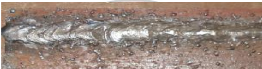
รูปที่ 5.42 แสดงแนวเชื่อมที่ใช้กระแสไฟฟ้าสูง
