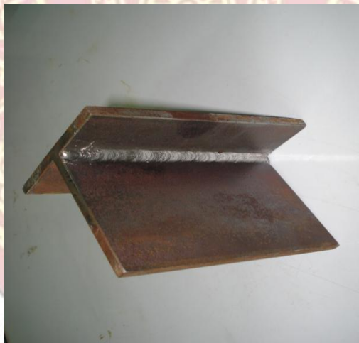
รูปที่ 5.63 แสดงตำแหน่งการเชื่อมตัวที่ทำเหนือศีรษะ
