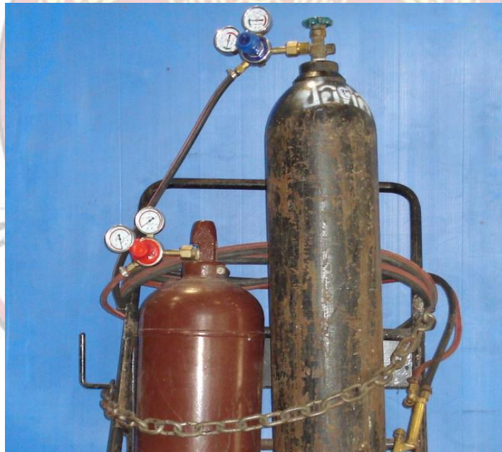
รูปที่ 1.9 แสดงการยึดถังต้องให้แน่นด้วยโซ่และจัดหัวปรับแก๊สให้อยู่ในตำแหน่งตลอดเวลา
