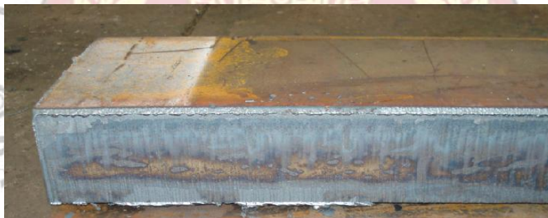
รูปที่ 4.11 แสดงลักษณะรอยตัดที่ดีผิวจะต้องเรียบสม่ำเสมอ
