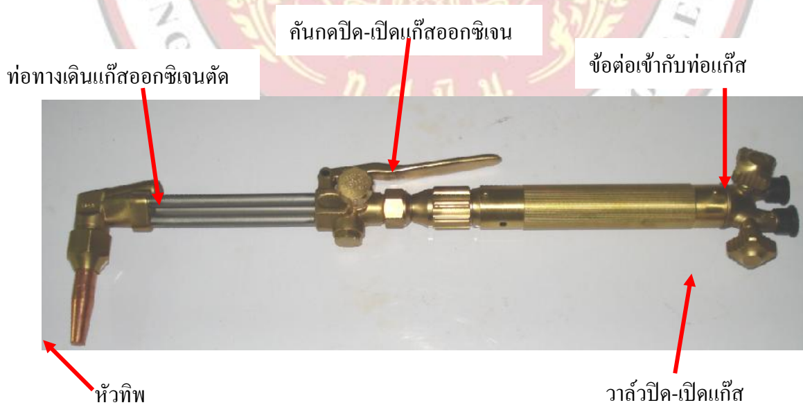
รูปที่ 4.4 แสดงรูปหัวตัดแก๊สออกซิอะเซทิลีนแรงดันสูง
