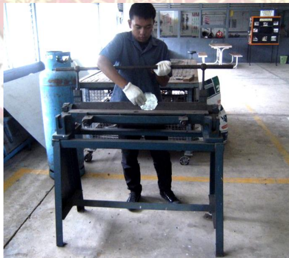
รูปที่ 6.34 แสดงลักษณะการใช้เครื่องพับแบบ Folder
