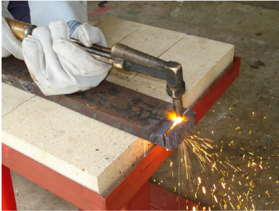
รูปที่ 4.1 แสดงการตัดโลหะด้วยแก๊ส
