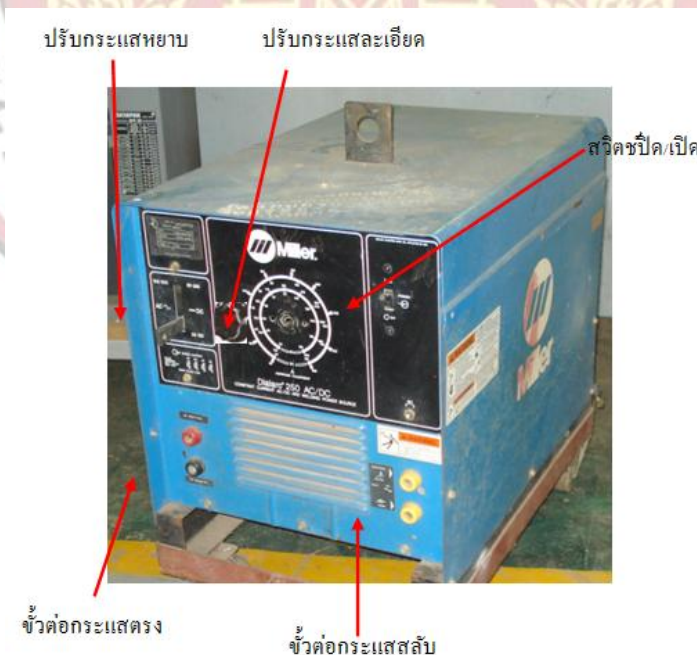
รูปที่ 5.19 แสดงรูปเครื่องเชื่อมแบบหม้อแปลง - เรียงกระแส
