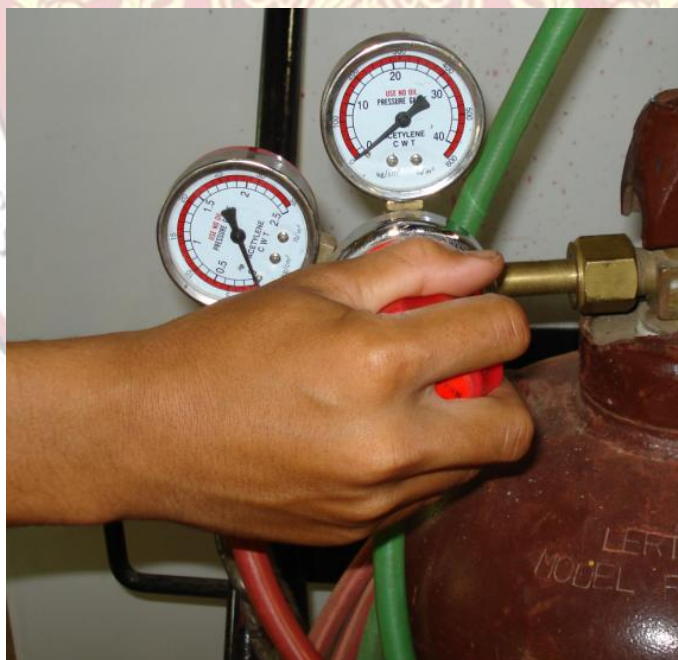
รูปที่ 1.11 แสดงการปรับความดันแก๊สให้เหมาะสมกับการใช้งาน
