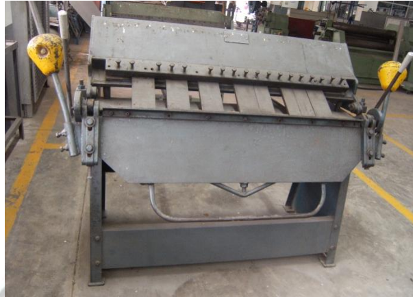
รูปที่ 6.35 แสดงลักษณะเครื่องพับแบบ Barker
