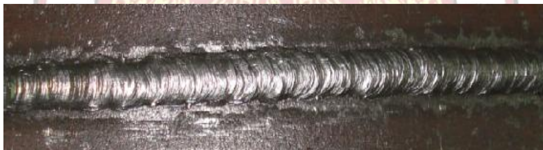
รูปที่ 5.43 แสดงแนวเชื่อมที่ใช้กระแสไฟฟ้าเหมาะสม
