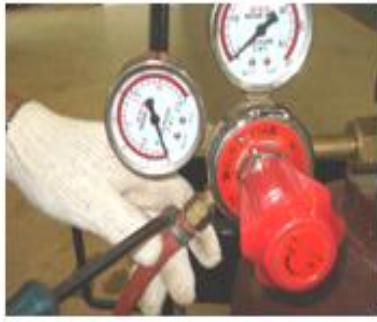
รูปที่ 1.38 แสดงรูปสายเชื่อมแก๊สที่ต่อเกลียวเข้ากับท่อแก๊สและหัวเชื่อม
