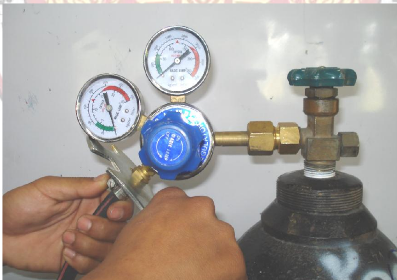
รูปที่ 1.22 แสดงการประกอบสายเชื่อมเข้ากับเครื่องควบคุมความดันถังแก๊สออกซิเจน
