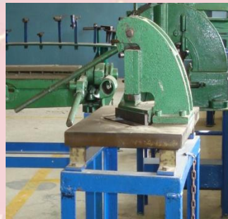
รูปที่ 6.38 แสดงลักษณะเครื่องตัดมุม (Notcher)
