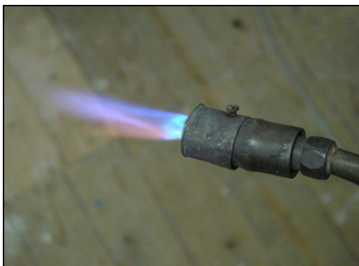
รูปที่ 3.16 แสดงเปลวแก๊สโพรเพน กับออกซิเจน ในการเชื่อมประสาน ที่มา : content.answers.com
