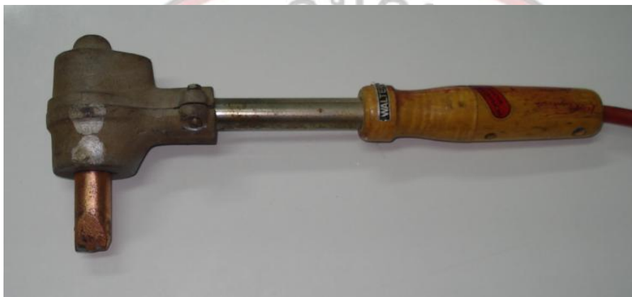
รูปที่ 9.4 แสดงหัวบัดกรีชนิดที่เกิดความร้อนด้วยตัวเอง (หัวบัดกรีไฟฟ้า)
