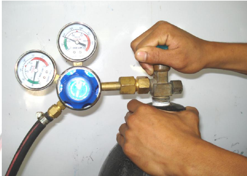
รูปที่ 1.23 แสดงการเปิดวาล์วถังแก๊สออกซิเจน
