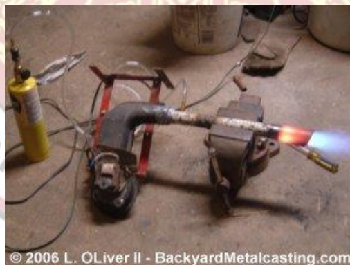
รูปที่ 3.15 แสดงเปลวแก๊ส MAPP กับออกซิเจน ในการเล่นประสาน
