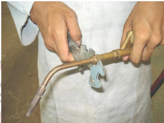
รูปที่ 1.25 แสดงการประกอบหัวเชื่อมแก๊สและหัวทิฟ
