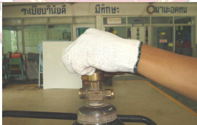
รูปที่ 1.20 แสดงการเปิดวาล์วถังแก๊สออกซิเจนที่ถูกต้อง
