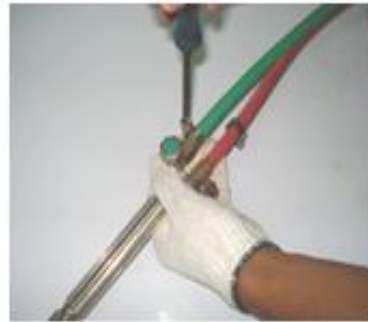
รูปที่ 1.38 แสดงรูปสายเชื่อมแก๊สที่ต่อเกลียวเข้ากับท่อแก๊สและหัวเชื่อม
