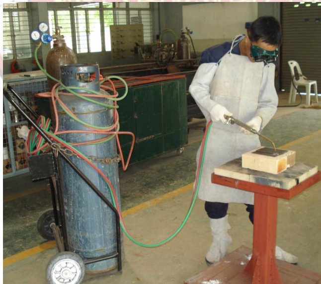
รูปที่ 3.6 แสดงชุดเชื่อมสนามด้วยแก๊สออกซี - แก๊สธรรมชาติ
