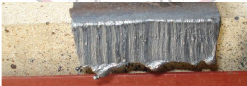
รูปที่ 4.12 แสดงลักษณะรอยตัดที่ไม่ดี หัวทิ่มสกปรก และการผสมของแก๊สไม่เหมาะสม
