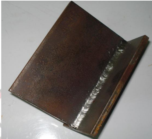
รูปที่ 5.60 แสดงตำแหน่งการเชื่อมตัวที่ทำราบ
