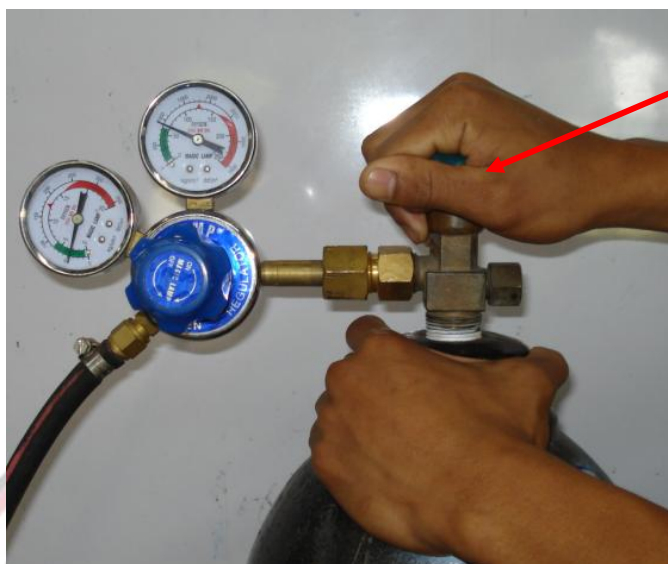
รูปที่ 1.10 แสดงการเปิด/ปิด ลิ้นหัวถัง (แก๊สออกซิเจน)
