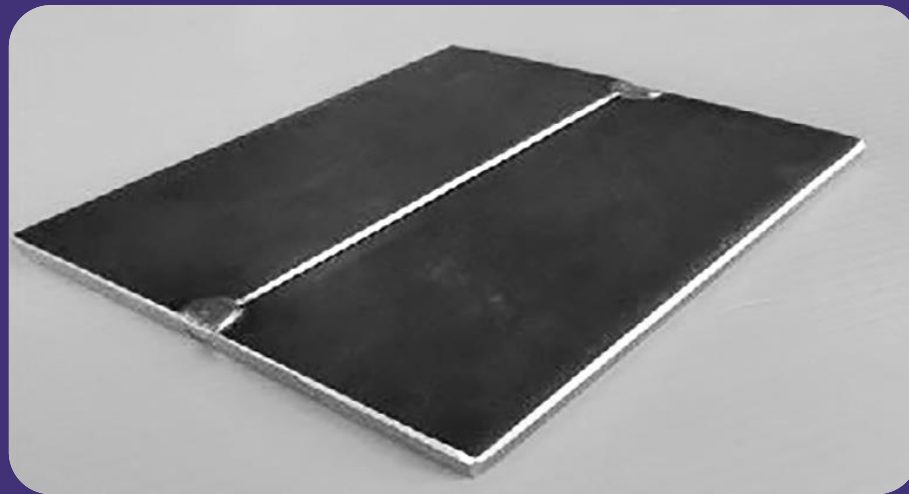
1) รอยต่อชน (Butt Joint)
