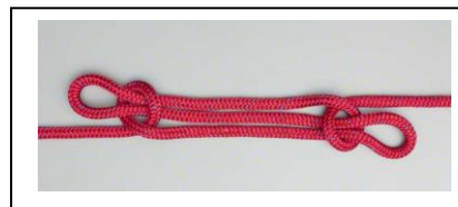
ภาพที่ 9.24 การผูกเงื่อนผูกกร่น
