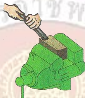
รูปที่ 5.19 การใช้ปลายตะไบชุดผิวดิบของชิ้นงานออก
