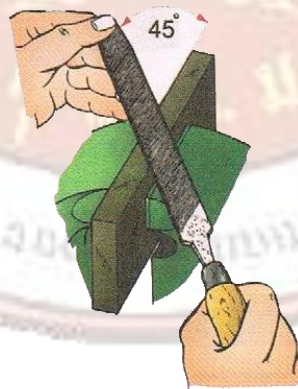
รูปที่ 5.17 การจับตะไบเอียง 45 องศา
