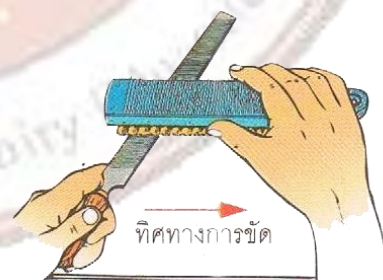
ข) ทิศทางการขัดแปรงทำความสะอาดตะไบ
