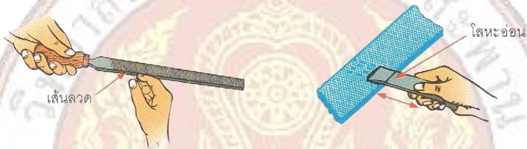
รูปที่ 5.23 การทำความสะอาดตะไบชิ้นงานด้วยเส้นลวดหรือโลหะอ่อน
