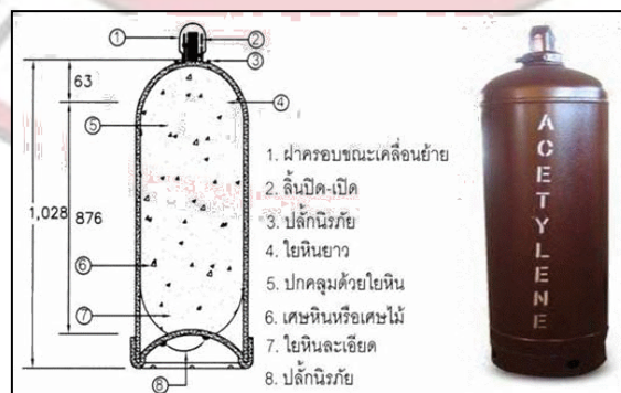
ลักษณะภายในของถังแก๊สอะเซทิลีน
