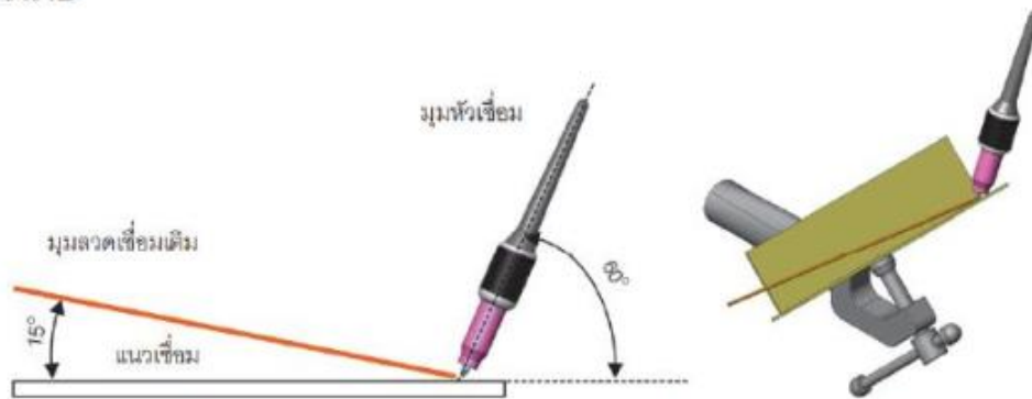
รูปที่ 5 การจัดมุมวางหัวเชื่อมและลวดเชื่อมในร่องรอยต่อที่
