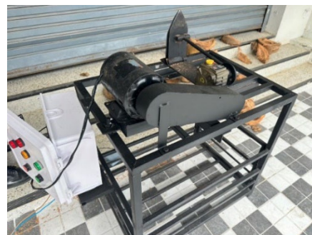
รูปที่ 4 การปอกเปลือกมะพร้าวของเครื่องปอกเปลือกมะพร้าวระบบไฟฟ้า
