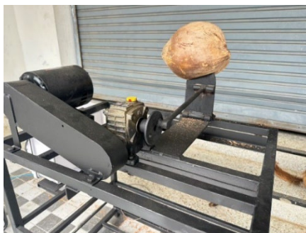
รูปที่ 4 การปอกเปลือกมะพร้าวของเครื่องปอกเปลือกมะพร้าวระบบไฟฟ้า
