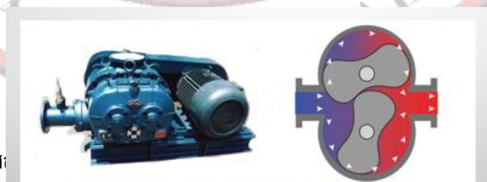
การทำงานของเครื่องอัดอากาศแบบใบพัดหมุน
