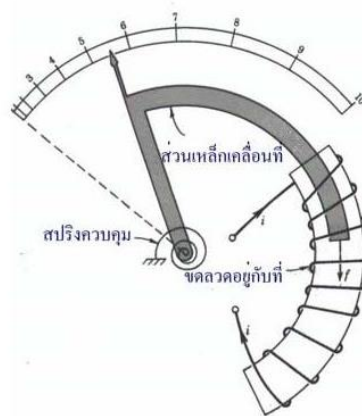
รูปที่ 3.15 เครื่องวัดแบบแผ่นเหล็กเคลื่อนที่ใช้แรงดูด
