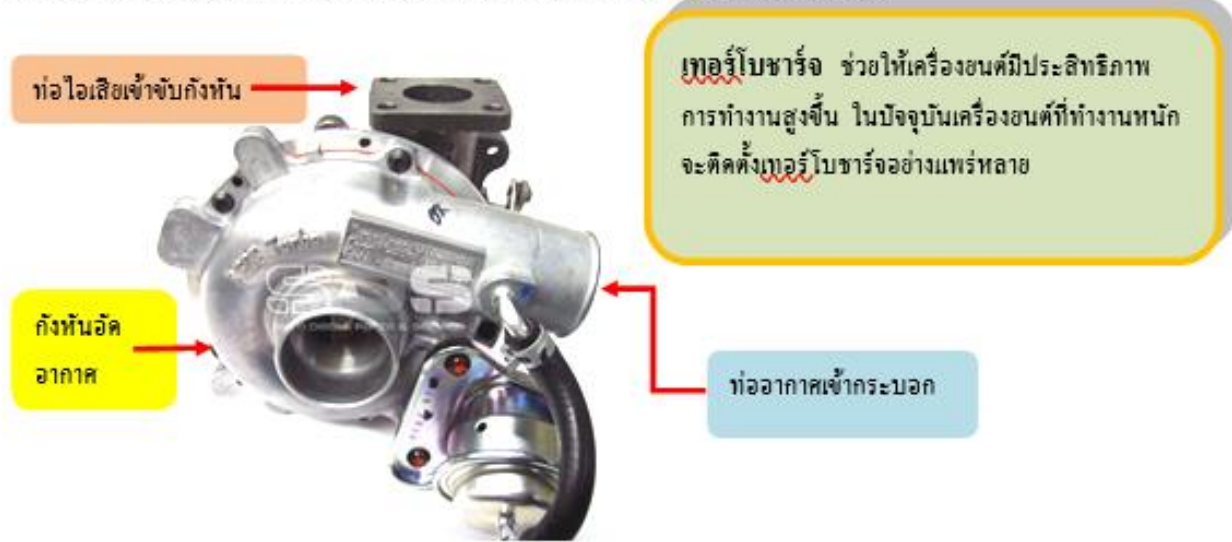
รูปที่ 11 - 14 เทอร์โบชาร์จ เป็นการนำไอเสียมาขบกับกังหัน อัดอากาศเข้ากระบอกลูกสูบ
