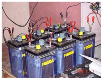
รูปที่ 17-2 แสดงการประจุไฟฟ้าแบบขนานหลายลูก
