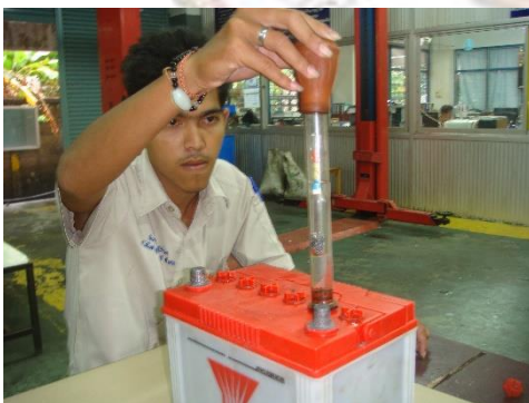
รูปที่ 14-2 แสดงการใช้ไฮโดรมิเตอร์เพื่อวัดค่าความถ่วงจำเพาะของสารละลาย (Electrolyte) ภายในแบตเตอรี่
