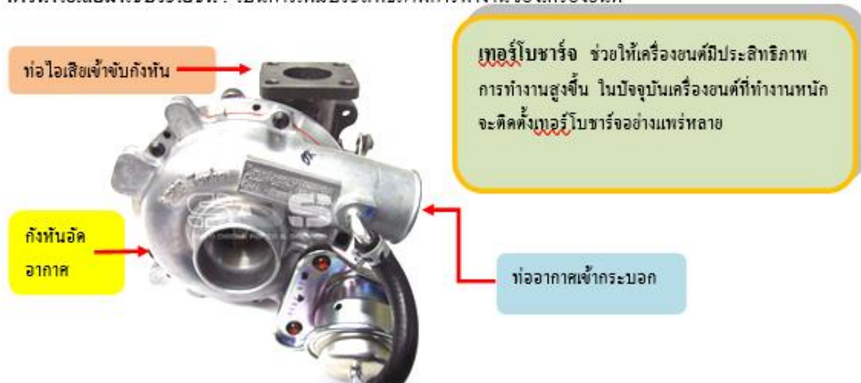
รูปที่ 11 - 14 เทอร์โบชาร์จ เป็นการนำไอเสียมาจับกังหัน อัดอากาศเข้ากระบอกสูบ
