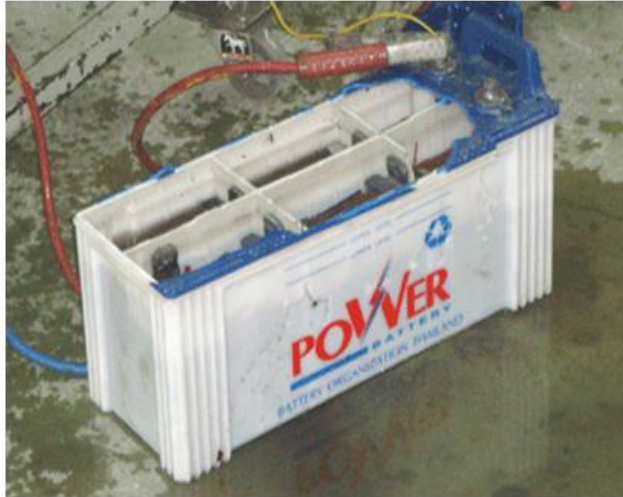
รูปที่ 18-2 แสดงภาพแบตเตอรี่เกิดการระเบิด ขณะทำการประจุ ภายในแผนกวิชาช่างยนต์ เมื่อ ธันวาคม 51
