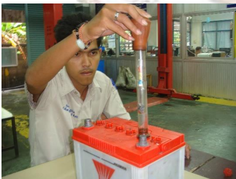
รูปที่ 14-2 แสดงการใช้ไฮโดรมิเตอร์เพื่อวัดค่าความถ่วงจำเพาะของสารละลาย (Electrolyte) ภายในแบตเตอรี่
