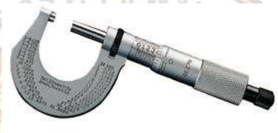
รูปที่ 3.26 ไมโครมิเตอร์วัดนอกวัดงานได้ ขนาด 0-1 นิ้ว ความละเอียด 0.001 นิ้ว
