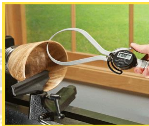
รูปที่ 5.10 การขยายคาลิปเปอร์ขาวัดทางออกเล็กกว่าศูนย์กลางของงาน
