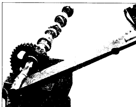
รูปที่ 17.1 ประกอบชิ้นส่วนต่างๆ ของเพลาลูกเบี้ยวและเฟืองขับ จากนั้นกดขันให้แน่นด้วยประแจวัดแรงบิด
