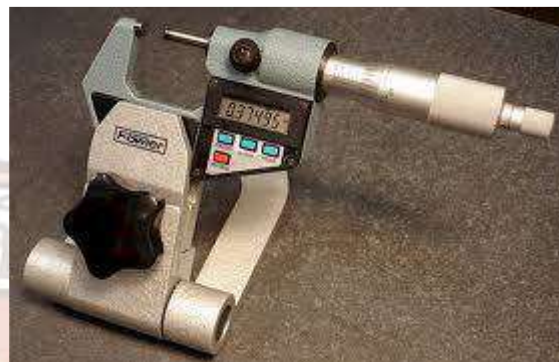
รูปที่ 3.37 แท่นจับยึดไมโครมิเตอร์สำหรับวัดงานลักษณะต่าง ๆ
