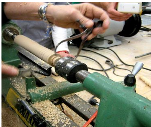
รูปที่ 5.29 การขยายคาลิปเปอร์ขาวัดทางออกใหญ่กว่าเส้นผ่าศูนย์กลางของงาน
