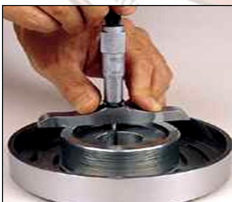
รูปที่ 3.100 การตรวจสอบความเที่ยงตรงของไมโครมิเตอร์วัดลึกลง
