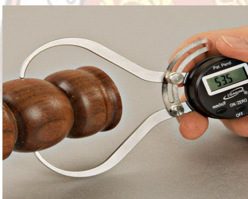
รูปที่ 5.31 การขยายคาลิปเปอร์ขาวัดทางออกพอดีกับเส้นผ่าศูนย์กลางของงาน
