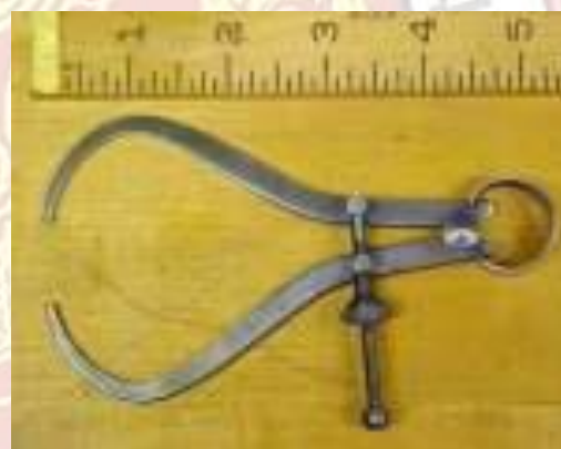
รูปที่ 5.32 การเปรียบเทียบขนาดคาลิปเปอร์จากบรรทัดวัด
