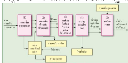
รูปที่ 10.2 แผนภูมิการผลิตน้ำมันหล่อลื่นพื้นฐานและน้ำมันเครื่องยนต์สำเร็จรูป
