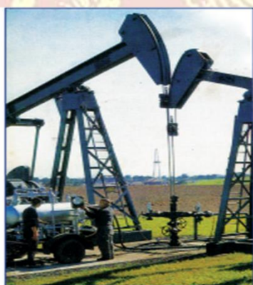
รูปที่ 1.8 เครื่องสูบลึงปิโตรเลียมขึ้นจากชั้นดินแบบทวีต
