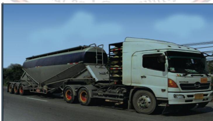
รูปที่ 9.3 ลักษณะรถบรรทุกซีเมนต์ใช้ก๊าซ NGV เป็นเชื้อเพลิง
