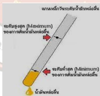
รูป 11.2 แสดงการวัดระดับน้ำมันหล่อลื่น
