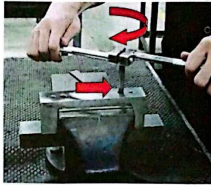
รูปที่ 5.44 แสดงการควั่นละเอียดด้วยมือ (ที่มา : ชัยกร สุขคำ. 2556.)
