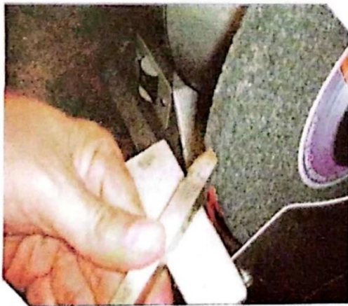
รูปที่ 3.22 แสดงการลัดด้านที่ 2 มุมหลบ ปลายมีดพร้อมลบมุมหลบข้าง
