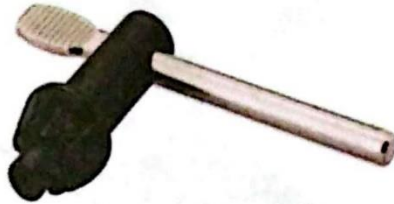
รูปที่ 5.11 แสดงลักษณะตัวขันหัวจับดอกสว่าน
