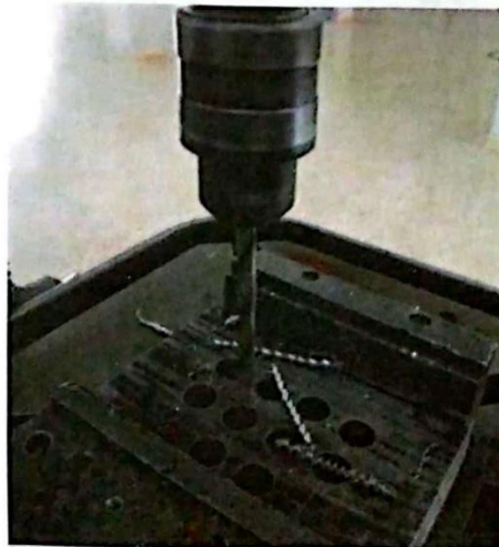
รูปที่ 5.34 แสดงการนำดอกสว่านเข้าหาชิ้นงานเพื่อที่จะทำการเจาะรู (ที่มา : ชัยกร สุขคำ. 2556.)
