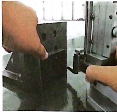
รูปที่ 5-29 แสดงการร่างแบบชิ้นงานเพื่อที่จะทำการเจาะรู (ที่มา : ชัยกร สุขคำ. 2556.)
