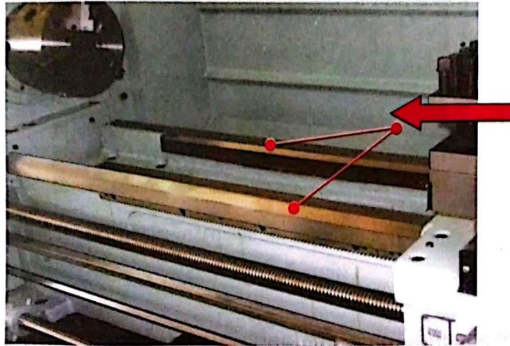
รูปที่ 4.22 แสดงลักษณะสะพานแท่นเลื่อน
