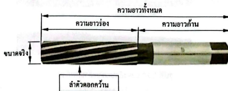
รูปที่ 5.21 แสดงลักษณะส่วนประกอบต่าง ๆ ของดอกคว้านละเอียด
