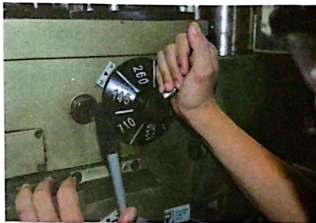
รูปที่ 5-37 แสดงการปรับความเร็วรอบของเครื่องเจาะตั้งพื้น (ที่มา : ชัยกร สุขคำ. 2556)
