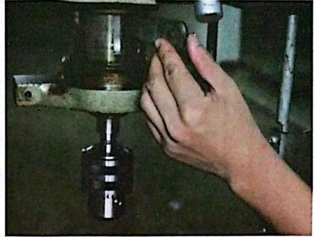
รูปที่ 5.14 แสดงการใช้ Drill drip ถอดหัวจับดอกสว่าน (ที่มา : ชัยกร สุขคำ. 2556.)
