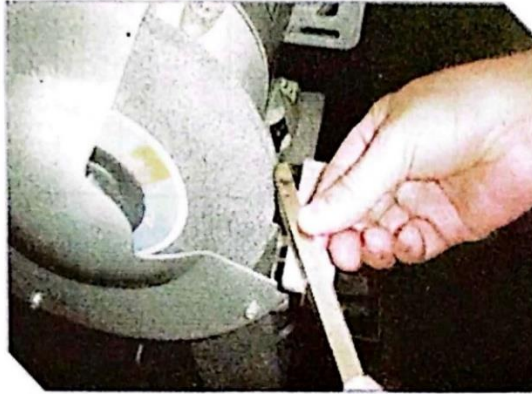
รูปที่ 3.21 แสดงการลัดด้านที่ 1 มุมคมตัดพร้อมทั้งลบมุมหลบข้าง
