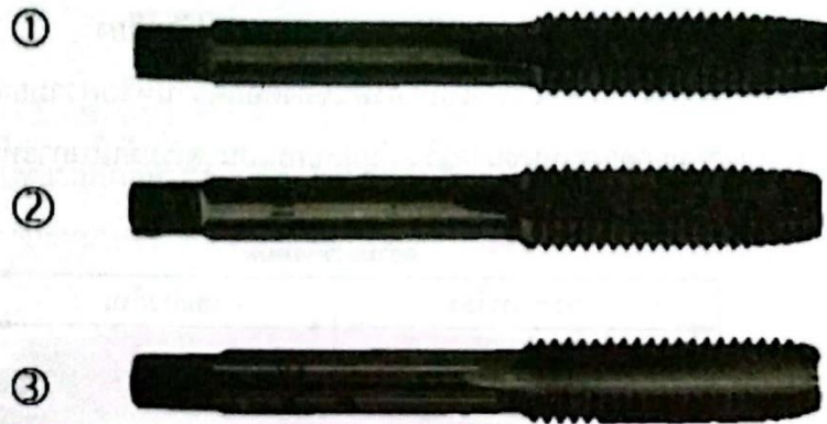
รูปที่ 5.20 แสดงลักษณะชุดตีแปด้วยมือ
