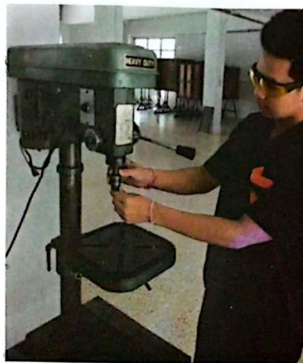
รูปที่ 5.30 แสดงการสวมหัวจับดอกสว่านเข้ากับเพลาของเครื่องเจาะ (ที่มา : ชัยกร สุขคำ. 2556.)
