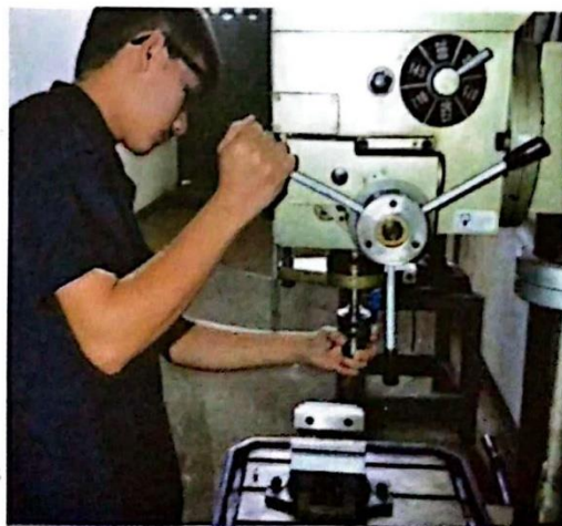
รูปที่ 5.38 แสดงการสวมหัวจับดอกสว่านเข้ากับเพลลาของเครื่องเจาะตั้งพื้น (ที่มา : ชัยกร สุขคำ 2556)
