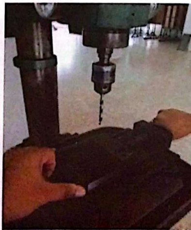
รูปที่ 5.32 แสดงการใช้ปากกาในการจับชิ้นงานที่จะทำการเจาะรู
