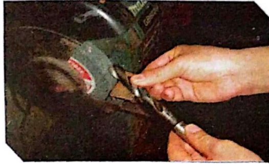
รูปที่ 3.35 แสดงวิธีการจับดอกสว่านเพื่อลบคม
