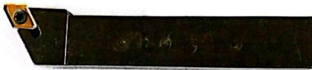
รูปที่ 4.35 แสดงลักษณะด้ามจับมีดกลึงแบบสำเร็จรูป
