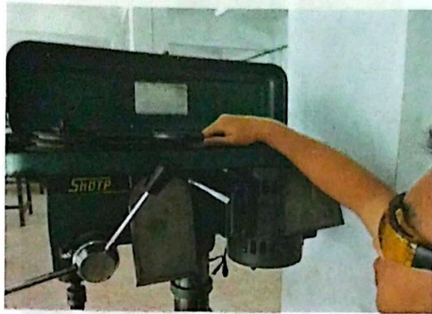
รูปที่ 5.31 แสดงการปรับความเร็วรอบของเครื่องเจาะตั้งโต๊ะ
