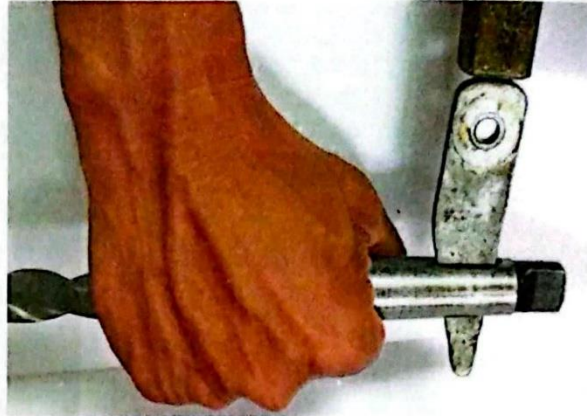
รูปที่ 5.17 แสดงการถอดปลอกเรียวออกจากดอกสว่าน (ที่มา : ชัยกร สุขคำ. 2556.)
