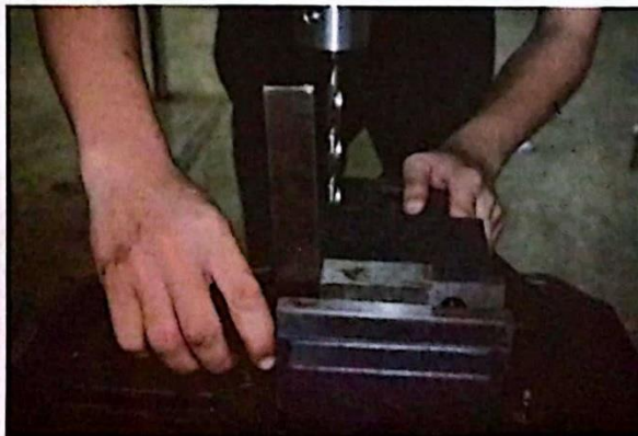
รูปที่ 5.40 แสดงการจับยึดชิ้นงานและทำการตรวจสอบความได้ฉากของชิ้นงาน (ที่มา : ชัยกร สุขคำ. 2556.)
