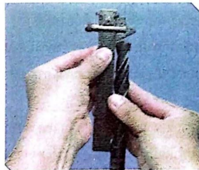
รูปที่ 3.36 แสดงวิธีการวัดมุมและวัดความกว้างคมตัดดอกสว่าน
