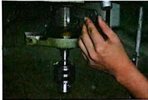
รูปที่ 5.43 แสดงการถอดหัวจับดอกสว่านออกจากเพลาเครื่องเจาะตั้งพื้น (ที่มา : ชัยกร สุขคำ. 2556.)
