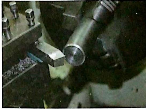
รูปที่ 4.47 แสดงการปรับมุมมีด 45 องศา เพื่อทำการลบคมชิ้นงาน
