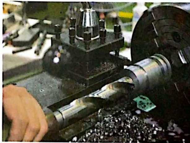
รูปที่ 4.52 แสดงการเจาะรูชิ้นงานบนเครื่องกลึง
