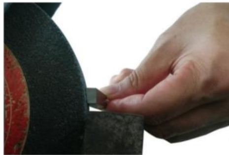
รูปที่ 4.77 แสดงการลับมุมหลบด้านข้างมิดกึ่งปกกซ้าย (ที่มา : สุรัชย์ บุญโสภณ, 2559)
