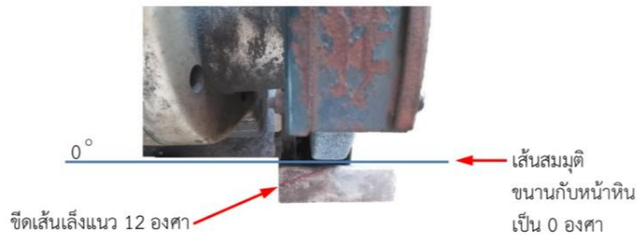
รูปที่ 4.52 แสดงเส้นสำหรับเล็งแนวมุมเอียงคมตัด (ที่มา : สุรัชย์ บุญโสภณ, 2559)
