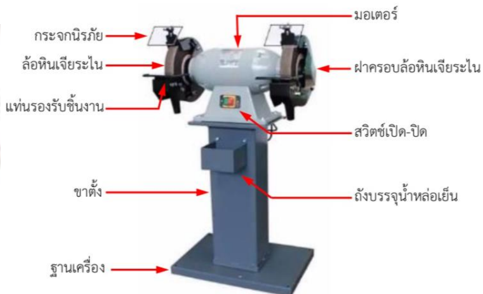
รูปที่ 2.4 แสดงส่วนประกอบของเครื่องเจียรในลับคมตัดแบบตั้งพื้น
