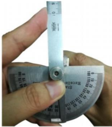
รูปที่ 4.113 แสดงการวัดตรวจสอบมุมหลบข้างขวา (ที่มา : สุรัชย์ บุญโสภณ, 2559)
