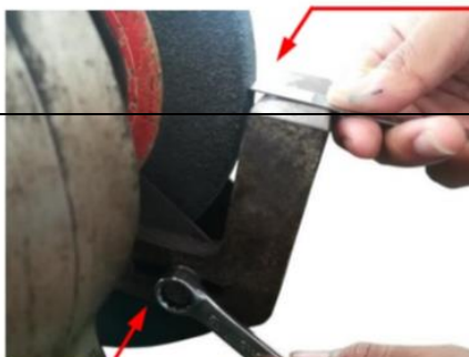
รูปที่ 3.15 แสดงลักษณะการเลื่อนด้ามจับล้อแต่งหน้าหินเจียรไน (ที่มา : สุรัชย์ บุญโสภณ, 2559)
