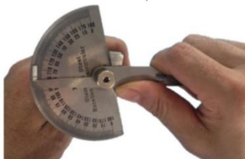
รูปที่ 4.68 แสดงการวัดตรวจสอบมุมคายข้าง (ที่มา : สุรัชย์ บุญโสภณ, 2559)
