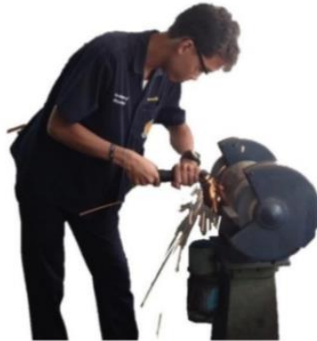
รูปที่ 5.26 แสดงลักษณะการแต่งหน้าล้อหินเจียระไน (ที่มา : สุรัชย์ บุญโสภณ, 2559)
