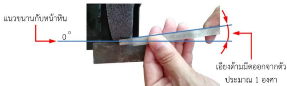
รูปที่ 4.109 แสดงการลับมุมเอียงหลบขวา (ที่มา : สุรัชย์ บุญโสภณ, 2559)
