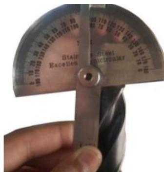
รูปที่ 5.33 แสดงลักษณะการวัดมุมหลบ 12 องศา ด้านที่ 1 (ที่มา : สุรัชย์ บุญโสภณ, 2559)
