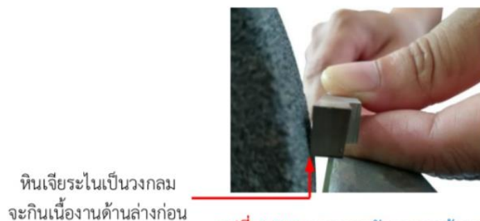
รูปที่ 4.110 แสดงการลับมุมหลบข้างขวา
