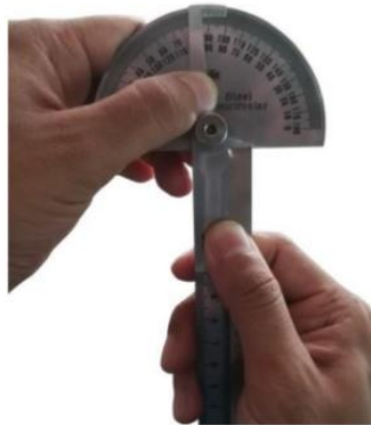
รูปที่ 4.97 แสดงการวัดตรวจสอบมุมฉากปลายมิด (ที่มา : สุรัชย์ บุญโสภณ, 2559)
