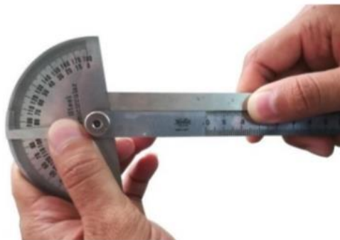
รูปที่ 4.98 แสดงการวัดตรวจสอบมุมหลบมุมหลบหน้ามิด (ที่มา : สุรัชย์ บุญโสภณ, 2559)
