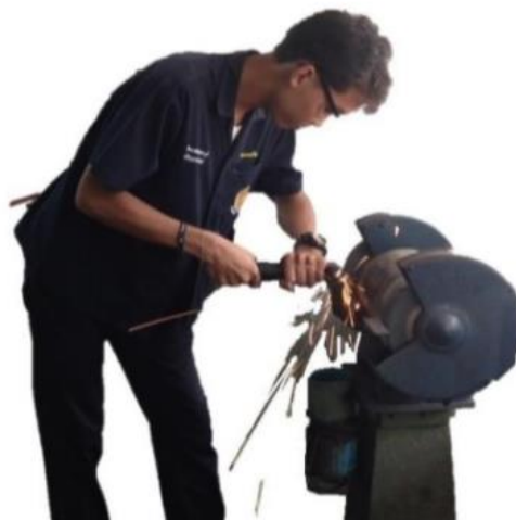
รูปที่ 3.14 แสดงลักษณะการจับด้ามล้อแต่งหน้าหินเจียรไนเพื่อแต่งหน้าล้อหินเจียรไน (ที่มา : สุรัชย์ บุญโสภณ, 2559)
