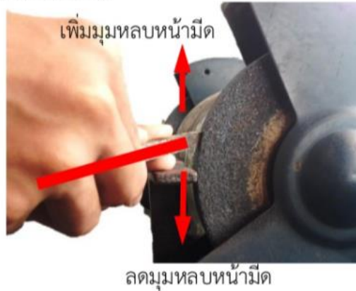
รูปที่ 4.65 แสดงแนวในการแก้ไขมุมหลบหน้ามีด (ที่มา : สุรัชย์ บุญโสภณ, 2559)
