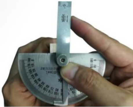
รูปที่ 4.106 แสดงการวัดตรวจสอบมุมหลบข้างซ้าย (ที่มา : สุรัชย์ บุญโสภณ, 2559)
