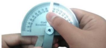
รูปที่ 4.84 แสดงการวัดตรวจสอบมุมรวมปลายมีด (ที่มา : สุรัชย์ บุญโสภณ, 2559)
