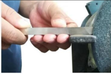
รูปที่ 4.96 แสดงการลัดมุมหลบหน้ามิด (ที่มา : สุรัชย์ บุญโสภณ, 2559)
