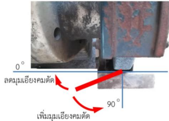
รูปที่ 4.57 แสดงแนวสมมุติ 0 องศาและ 90 องศา เพื่อแก้ไขมุมเอียงคมตัด (ที่มา : สุรัชย์ บุญโสภณ, 2559)
