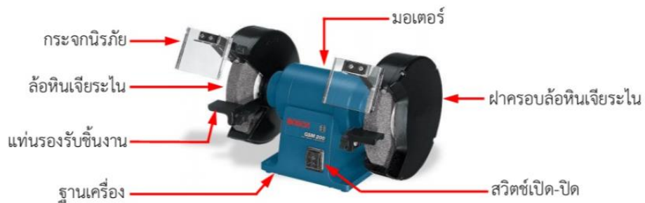
รูปที่ 3.3 แสดงส่วนประกอบของเครื่องเจียรในลับคมตัดแบบตั้งโต๊ะ
