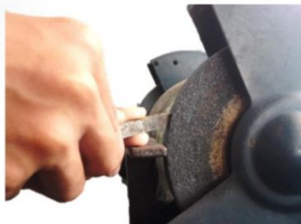
รูปที่ 4.61 แสดงการลับมุมหลบหน้ามีด (ที่มา : สุรัชย์ บุญโสภณ, 2559)
