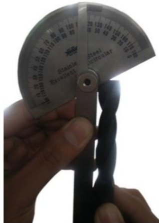
รูปที่ 5.32 แสดงลักษณะการวัดมุมจิก 59 องศา ด้านที่ 1 (ที่มา : สุรัชย์ บุญโสภณ, 2559)
