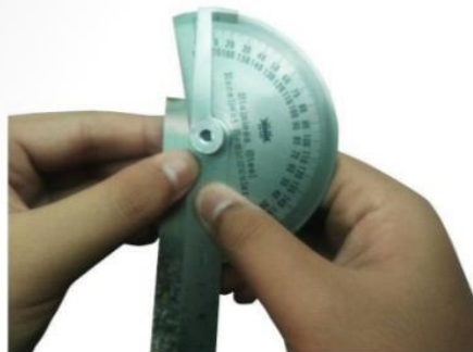
รูปที่ 4.78 แสดงการวัดตรวจสอบมุมเอียงคมตัดมิดกึ่งปกกซ้าย (ที่มา : สุรัชย์ บุญโสภณ, 2559)
