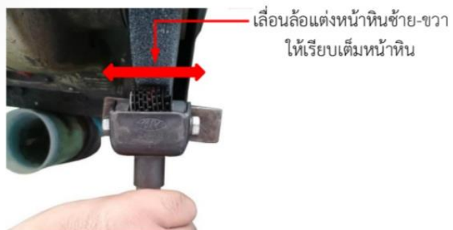
รูปที่ 3.15 แสดงลักษณะการเลื่อนด้ามจับล้อแต่งหน้าหินเจียรไน (ที่มา : สุรัชย์ บุญโสภณ, 2559)
