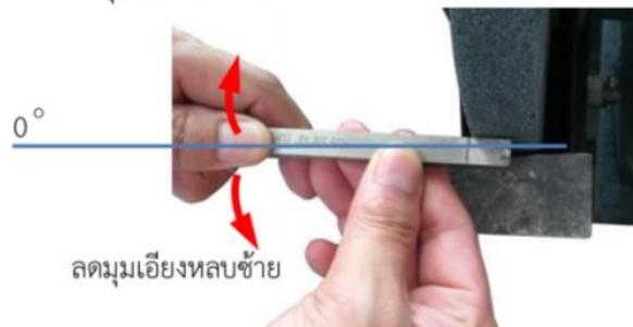
รูปที่ 4.107 แสดงแนวในการแก้ไขมุมเอียงหลบซ้าย (ที่มา : สุรัชย์ บุญโสภณ, 2559)
