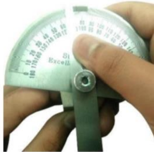
รูปที่ 4.90 แสดงการวัดตรวจสอบมุมคายข้าง (ที่มา : สุรัชย์ บุญโสภณ, 2559)
