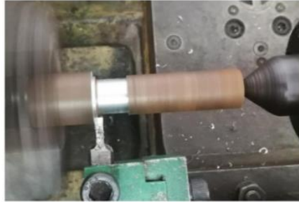
รูปที่ 4.92 แสดงลักษณะการกลึงเซาะร่อง (ที่มา : สรุชัย บุญโสภณ, 2559)
