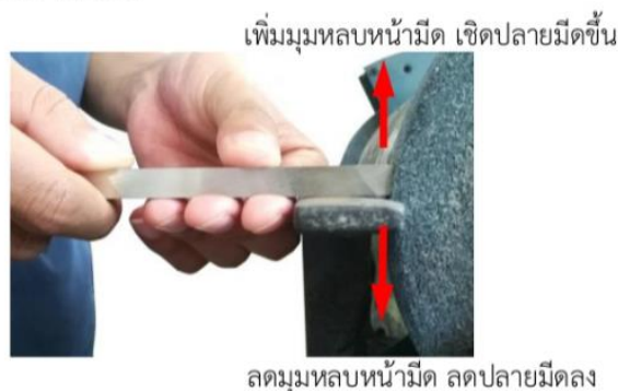
รูปที่ 4.100 แสดงแนวในการแก้ไขมุมหลบด้านข้าง (ที่มา : สุรัชย์ บุญโสภณ, 2559)
