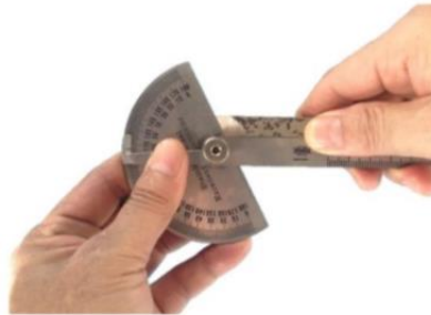
รูปที่ 4.63 แสดงการวัดตรวจสอบมุมหลบหน้ามีด (ที่มา : สุรัชย์ บุญโสภณ, 2559)
