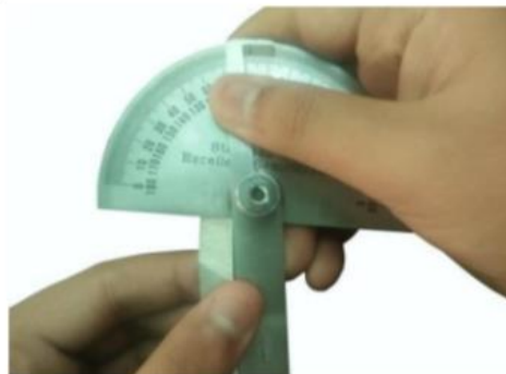
รูปที่ 4.85 แสดงการวัดตรวจสอบมุมหลบหน้ามีด
