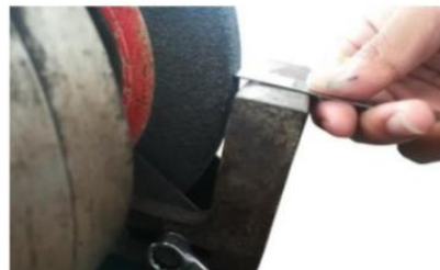
รูปที่ 5.27 แสดงการปรับระยะของแท่นรองรับชิ้นงานกับล้อหินเจียระไน (ที่มา : สุรัชย์ บุญโสภณ, 2559)
