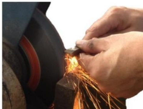
รูปที่ 4.67 แสดงการลับคมมีดปาดหน้าด้านที่ 3 (ที่มา : สุรัชย์ บุญโสภณ, 2559)
