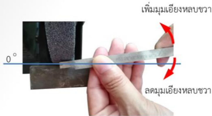
รูปที่ 4.115 แสดงแนวในการแก้ไขมุมเอียงหลบขวา (ที่มา : สุรัชย์ บุญโสภณ, 2559)
