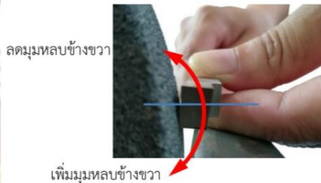
รูปที่ 4.116 แสดงแนวในการแก้ไขมุมหลบข้างขวา (ที่มา : สุรัชย์ บุญโสภณ, 2559)
