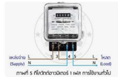
ภาพที่ 5 กิโลวัตต์ฮาวมิเตอร์ 1 เฟส การใช้งานทั่วไป โรงเรียนศูนย์ฝึกวิชาชีพพระยาสัน มิเตอร์ไฟฟ้า คืออะไรกันหว่า ? ข้างไฟอย...
