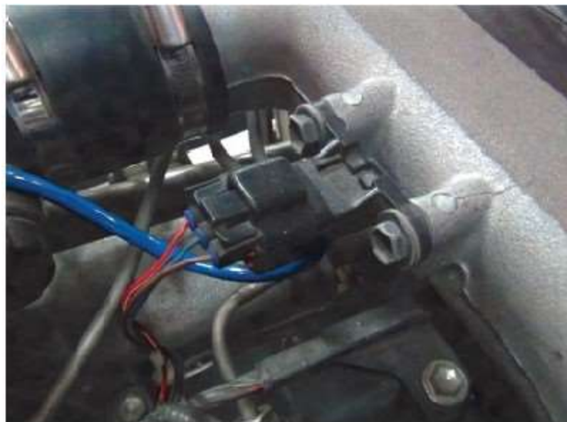
ตำแหน่งติดตั้งตัวเซนเซอร์
