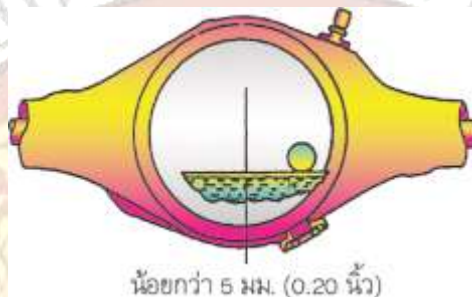
รูปที่ 5.2 การตรวจระดับน้ำมันเฟืองท้าย
