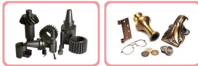
ภาพที่ 10.11 ตัวอย่างชิ้นงานที่รมดำ
