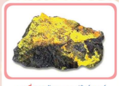
ภาพที่ 4.26 ลักษณะของแร่พิชต์เบลนด์ (Pitch Blende) สำหรับถลุงยูเรเนียม
