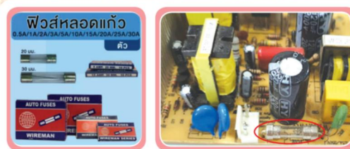
ภาพที่ 9.5 ลักษณะของฟิวส์หลอดแก้ว และการใช้งานวงจรอิเล็กทรอนิกส์
