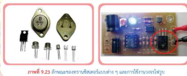
ภาพที่ 9.23 ลักษณะของทรานซิสเตอร์แบบต่าง ๆ และการใช้งานวงจรไฟฟ้
