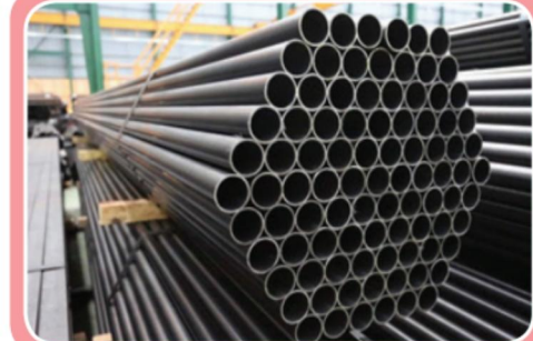
ภาพที่ 3.5 ท่อเหล็กทำจากเหล็กกล้าคาร์บอนปานกลาง
