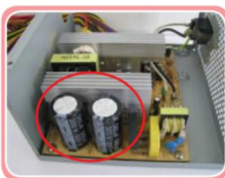
ภาพที่ 9.21 ตัวเก็บประจุ และการใช้งานวงจรไฟฟ้า
