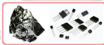
ภาพที่ 4.27 ลักษณะของเจอร์เมเนียม และการใช้ทำทรานซิสเตอร์
