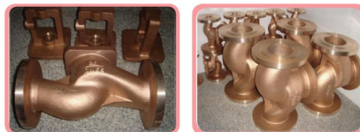
ภาพที่ 4.41 ลักษณะชิ้นงานทำจากทองแดงหล่อ
