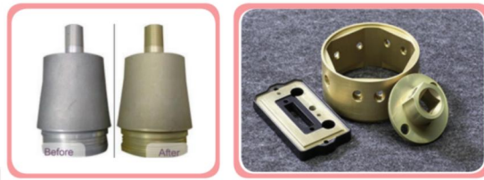
ภาพที่ 10.15 ตัวอย่างชิ้นงานก่อนและหลังใช้ปฏิกิริยาเคมีสร้างชั้นเคลือบ
