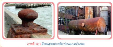
ภาพที่ 10.1 ลักษณะของการกัดกร่อนแบบสม่ำเสมอ
