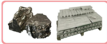
ภาพที่ 4.16 ลักษณะของแร่บิสมัท และโลหะดีบุก ผสมบิสมัทหล่อแม่พิมพ์
