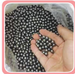
ภาพที่ 3.15 ลูกบอลกลมในบรรจุลูกปิ่น ทำจากเหล็กหล่อสีเทา
